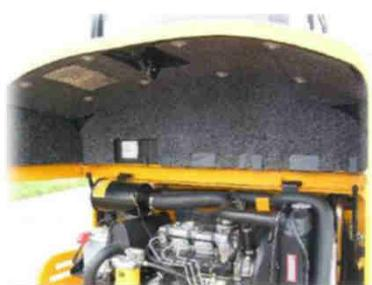
La structure rigide d'AcouPlast® lui permet d'être utilisé en **panneaux autoportants**, grâce à des modes de fixation adaptés. Néanmoins, il se plie facilement et s'adapte à des **supports courbés**.
